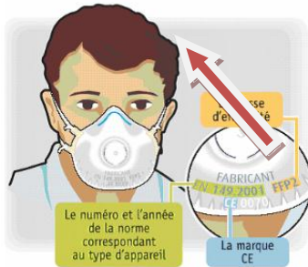
Figure 5 : Mentions obligatoires sur un appareil de protection respiratoire jetable contre les particules (document INRS)
